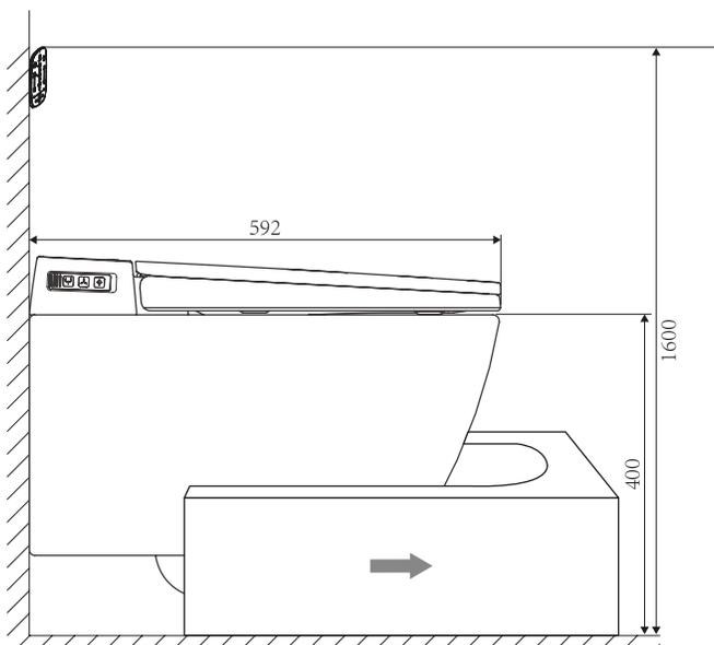
6. Wenn die Montage abgeschlossen ist, entfernen Sie die Verpackung in Richtung der Pfeile. Zur komfortablen Bedienung die Fernbedienungseinheit in einer Höhe ca. 1600 mm vom Boden installieren.
