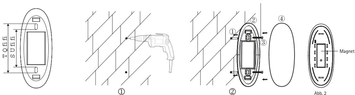
Nach Einsetzen der Batterien die Fernbedienung auf die Bodenplatte setzen; die Grundplatte nimmt die Fernbedienung automatisch auf.
